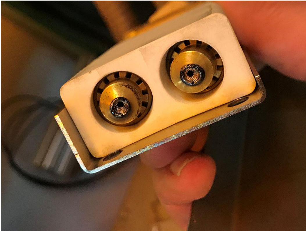
CAT-Elektroden, ca. 4.000 h, noch nutzbar
